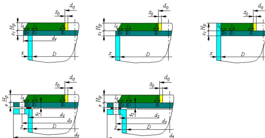
Рис. 3.52 Варианты исполнения дна с ребрами по EN 13445-3
