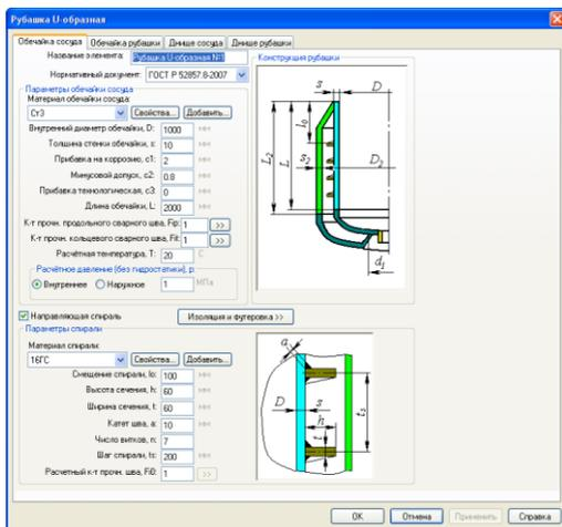
Рис. 3.174. Рубашка U-образная: обечайка сосуда
