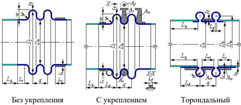
**Рис. 3.157. Исполнения компенсатора по ASME VIII-1**
