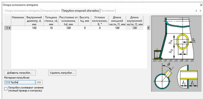
Рис. 3.142. Патрубки опорной обечайки
