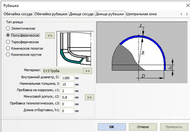
Рис. 3.177. Рубашка U-образная: днище рубашки
