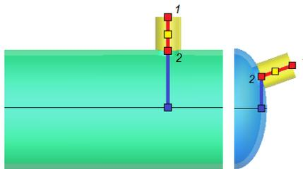
Рис. 3.68 Моделирование штуцера балочными элементами
