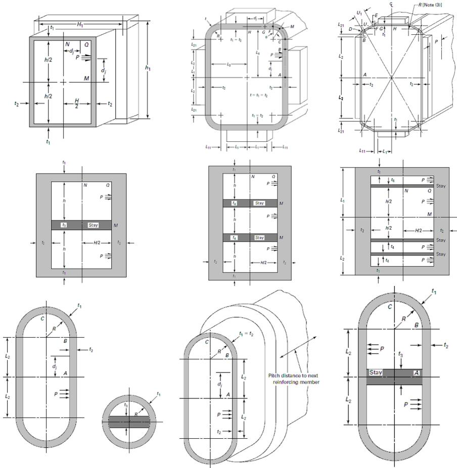
**Рис. 3.223** Варианты исполнения некруглого элемента по ASME VIII-1
