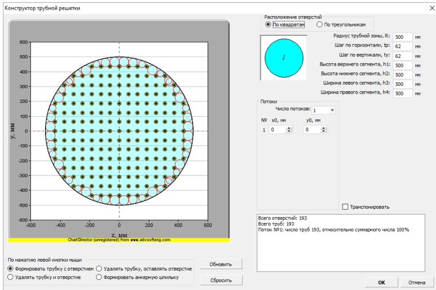
Рис. 3.154. Конструктор трубного пучка
