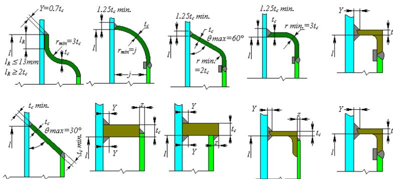
Рис. 3.173. Типы рубашек по ASME VIII-1
