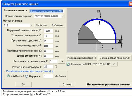
Рис. 3.42 Полусферическое днище
