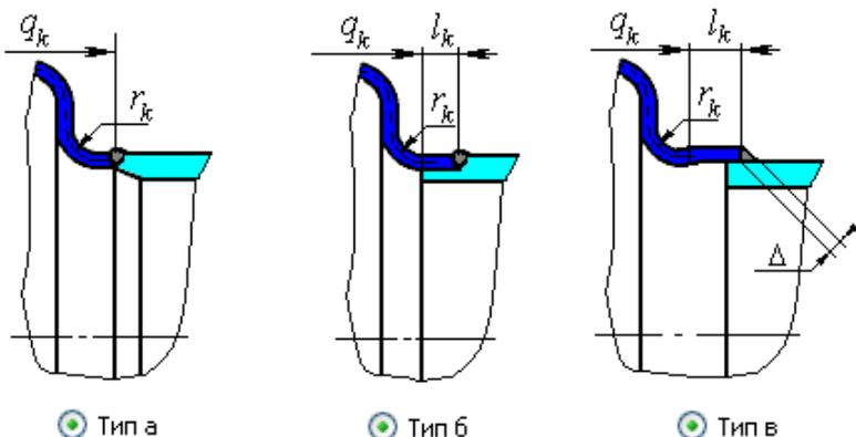
**Рис. 3.156. Соединение компенсатора с кожухом по ГОСТ 30780-2002**
