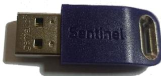
**Рис. 2.8.** Современная модель ключа Sentinel SuperPro/Sentinel HL
