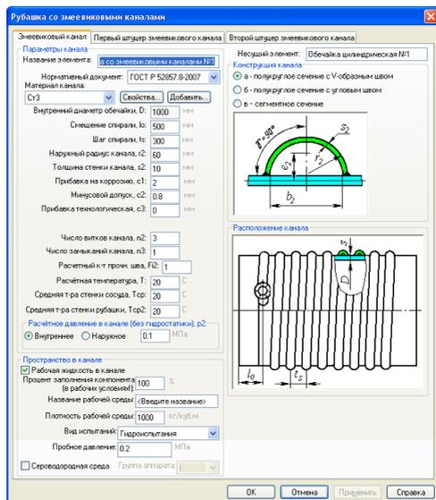
Рис. 3.182. Рубашка со змеевиковыми каналами
