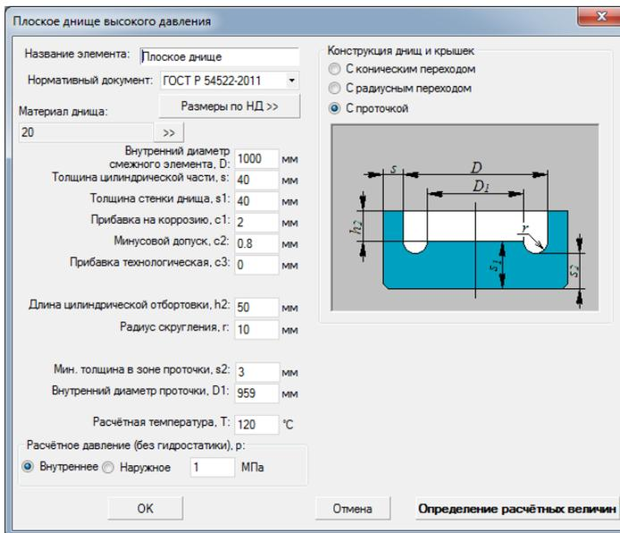
Рис. 3.205 Плоское днище высокого давления
