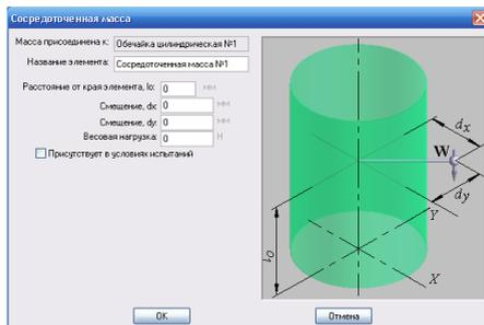
Рис. 3.123. Весовые нагрузки на вертикальный аппарат
