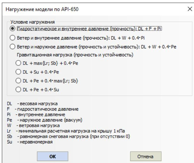
Рис. 3.235 Нагружение модели резервуара согласно API-650
