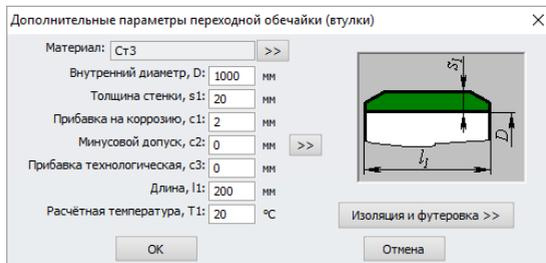
**Рис. 3.149. Параметры переходной обечайки**
