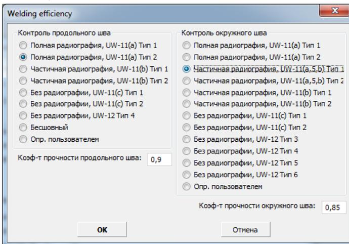
Рис. 3.23 Коэффициент прочности сварного шва по ASME VIII-1
