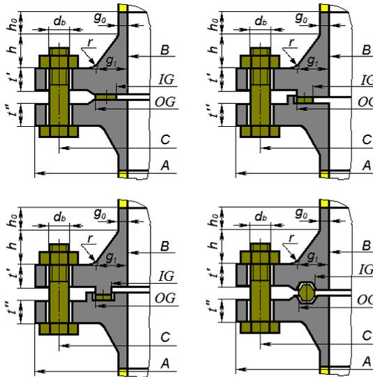
**Рис. 3.79 Варианты исполнений фланцевого соединения по ASME**
