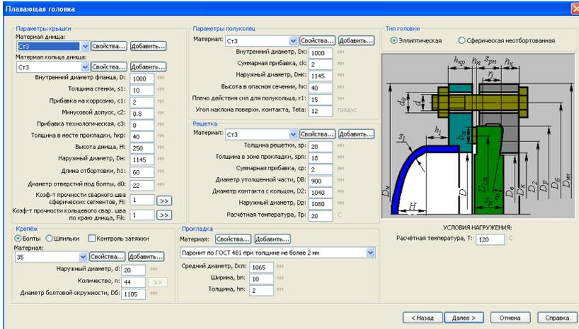
Рис. 3.162. Плавающая головка
