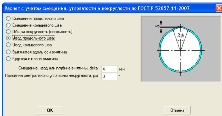
**Рис. 3.31** Параметр концентратора напряжений для расчета дефекта
