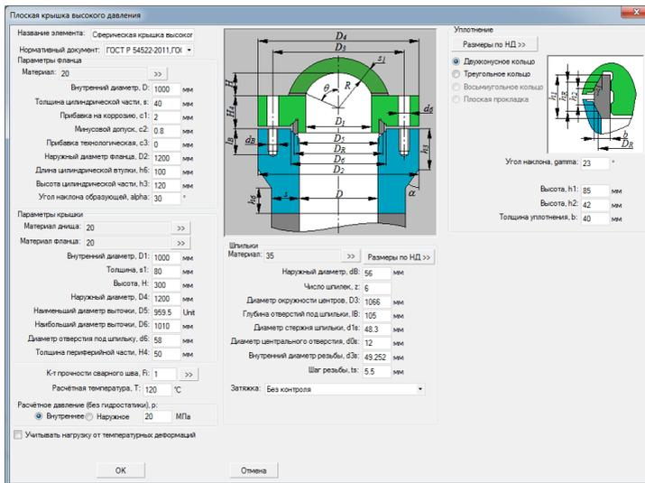
Рис. 3.208 Сферическая крышка высокого давления
