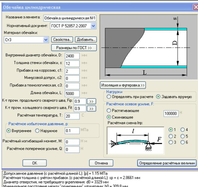
Рис. 4.2 Контрольный пример: обечайка
