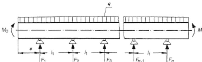
Рис. 3.106 Расчетная схема горизонтального сосуда по ГОСТ 34233.5
