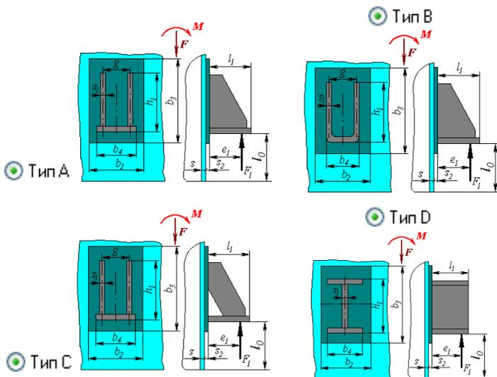
Рис. 3.109 Варианты исполнения опорных лап
