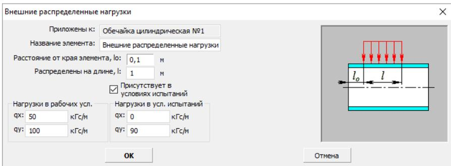
Рис. 3.125 Внешние нагрузки, распределенные по длине элемента
