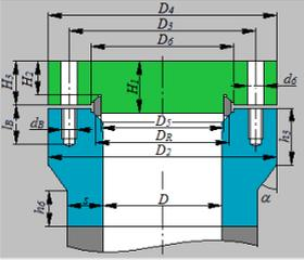
Рис. 3.207 Плоская крышка высокого давления
