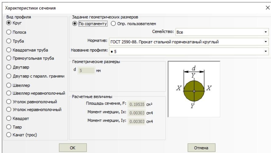
Рис. 3.33 Параметры поперечного сечения
