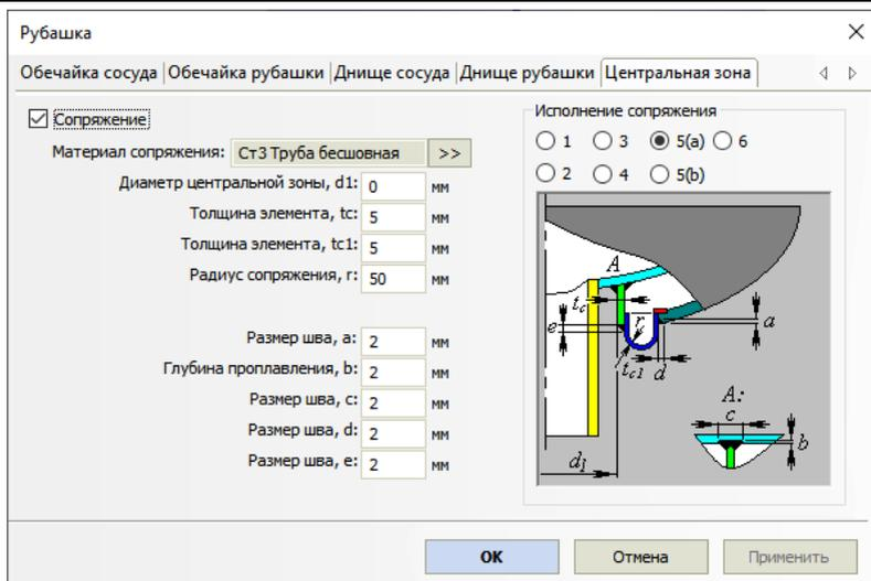
Рис. 3.178. Рубашка U-образная: центральное сопряжение
