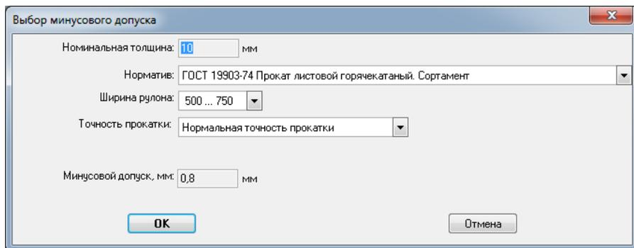
Рис. 3.21 Назначение минусового допуска из базы данных
