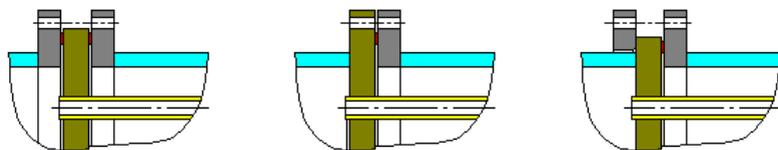
**Рис. 3.161** Конфигурации трубных решеток по ASME VIII-1
