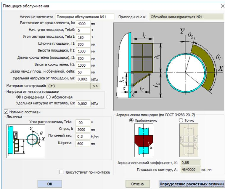
Рис. 3.127. Площадка обслуживания вертикального аппарата
