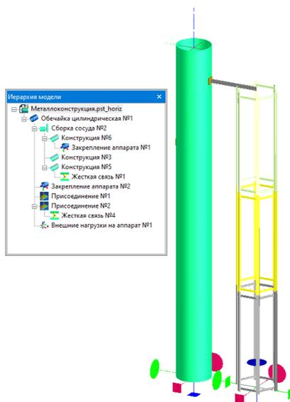
Рис. 3.193. Моделирование этажерки металлоконструкцией
