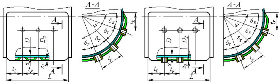
Рис. 3.181. Типы соединений рубашки с корпусом
