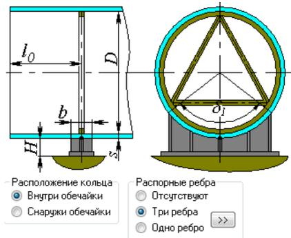
**Рис. 3.101 Распорные ребра внутри кольца опоры**
