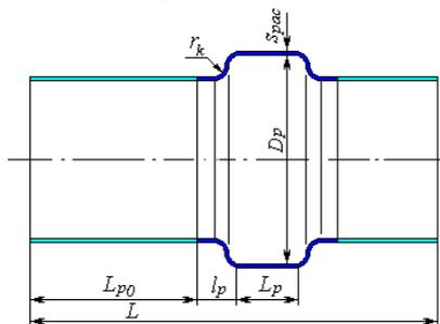
Рис. 3.159. Расширитель с полу-линзовыми концевыми участками
