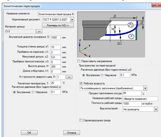
Рис. 3.188. Эллиптическая перегородка
