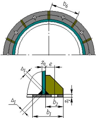
**Рис. 3.140** Варианты исполнения опорного узла
