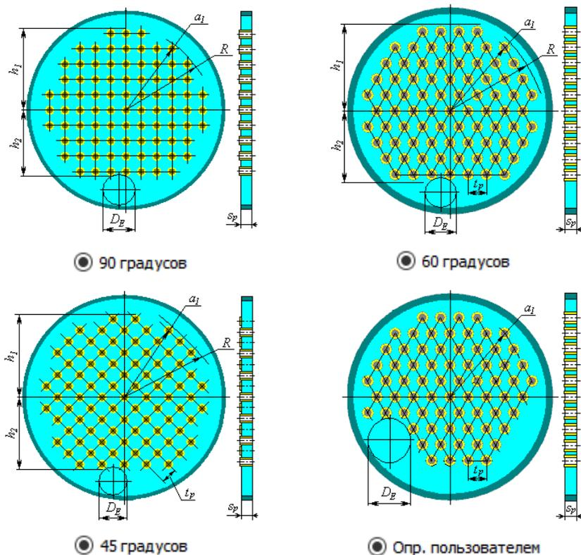
**Рис. 3.151. Расположение отверстий**
