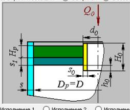
Снежный элемент: Обечайка цилиндрическая №1
