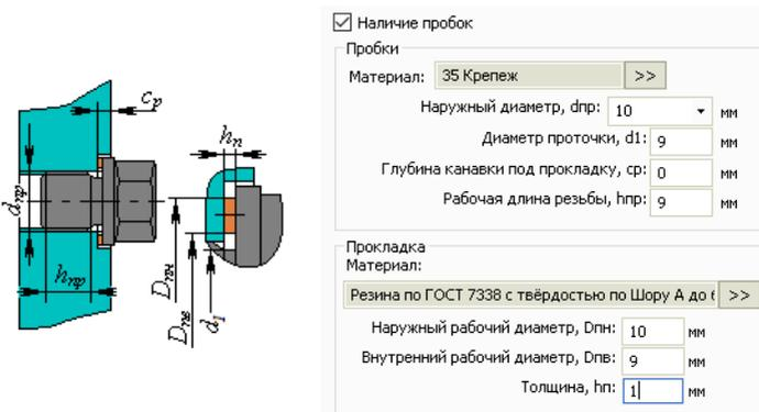
Рис. 3.168. Резьбовые пробки в распределительной камере
