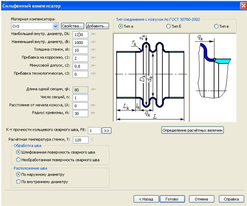
Рис. 3.155. Линзовый компенсатор
