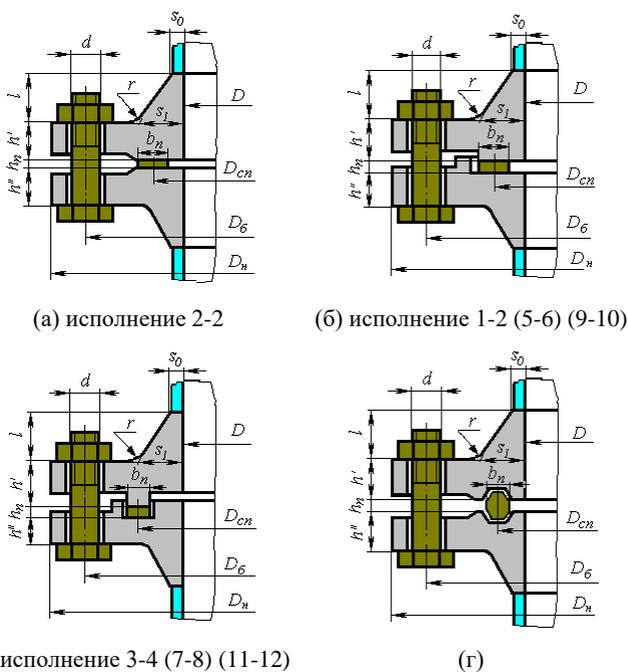
**Рис. 3.74. Фланцы, приварные встык по ГОСТ 28759.3-90(а,б,в) и ГОСТ 28759.4-90(г)**
