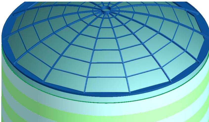
**Рис. 3.198. Импортированная модель каркаса крыши**
