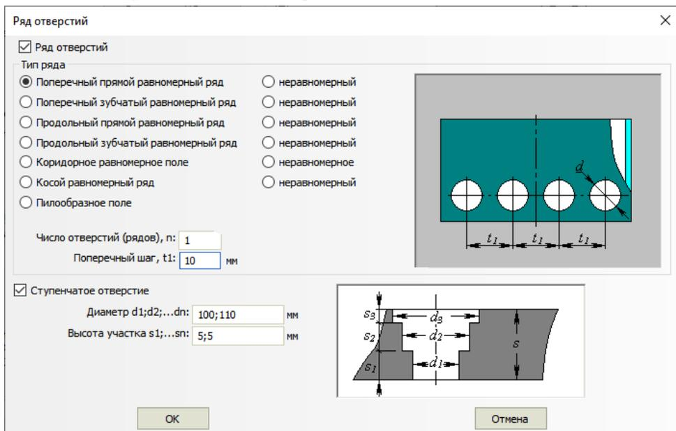
**Рис. 3.65 Опции “Ряд отверстий” и “Ступенчатое отверстие”**
