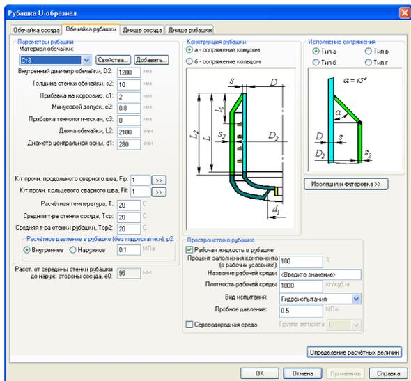
Рис. 3.175. Рубашка U-образная: обечайка рубашки
