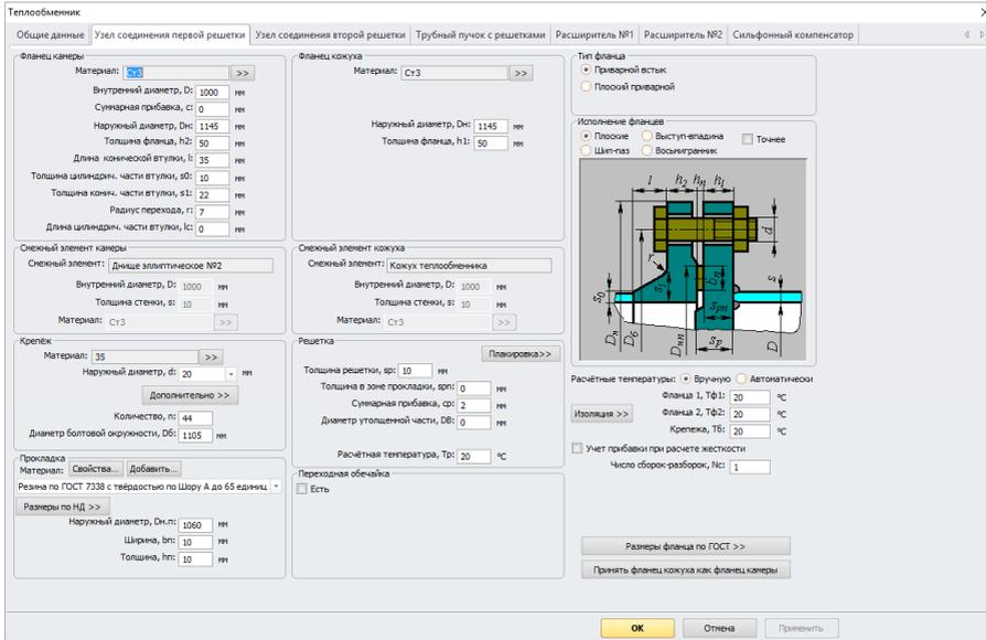
**Рис. 3.148. Узел соединения первой решетки**
