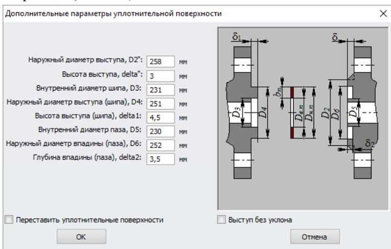
Рис. 3.84 Параметры уплотнительных поверхностей
