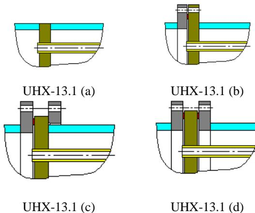
Рис. 3.147. Крепление трубной решетки по ASME VIII-1
