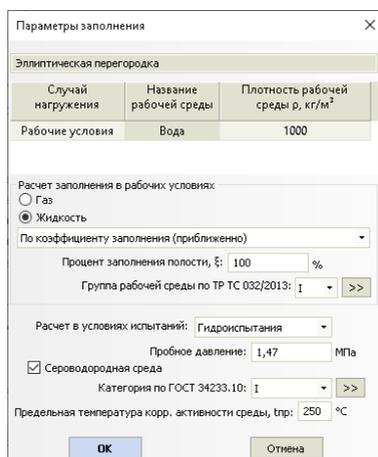
**Рис. 3.32** Параметры заполнения дочернего объема
