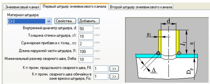
Рис. 3.184. Штуцер змеевикового канала
