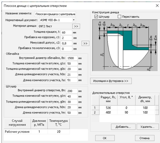
Рис. 3.53 Плоское днище с центральным отверстием
