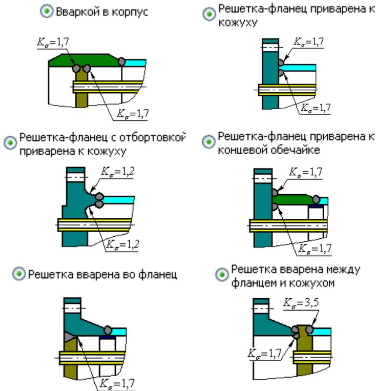
Рис. 3.146. Крепление трубной решетки по ГОСТ 34233.7-2017
