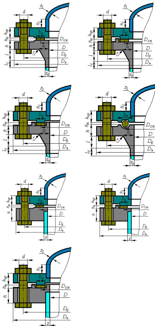
Рис. 3.93. Эллиптические отъемные крышки по РД 26-15-88, ГОСТ 34233.4-2017
