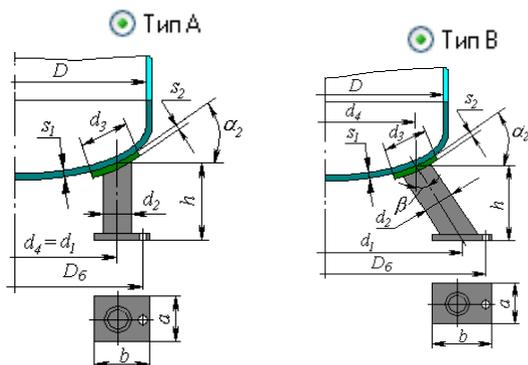
Рис. 3.111 Варианты исполнения опорных стоек
