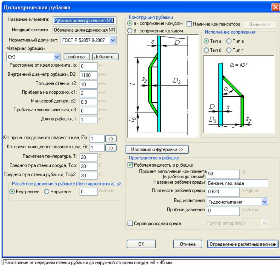
Рис. 3.171. Рубашка цилиндрическая
