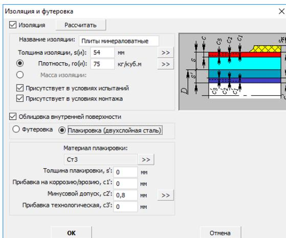
**Рис. 3.28** Изоляция и футеровка с возможностью назначения лакирующего слоя
