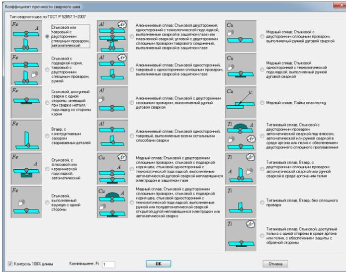
Рис. 3.22 Коэффициент прочности сварного шва по ГОСТ
