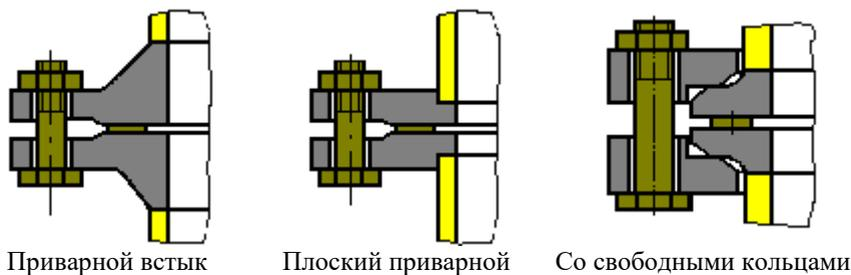
**Рис. 3.73 Типы фланцевых соединений**
