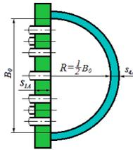
Неразъемная со сварной полуцилиндрической крышкой
