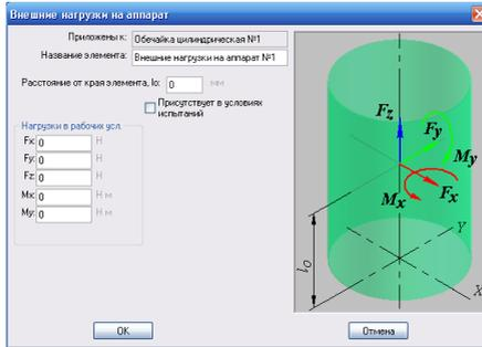
Рис. 3.124. Внешние нагрузки на вертикальный аппарат
