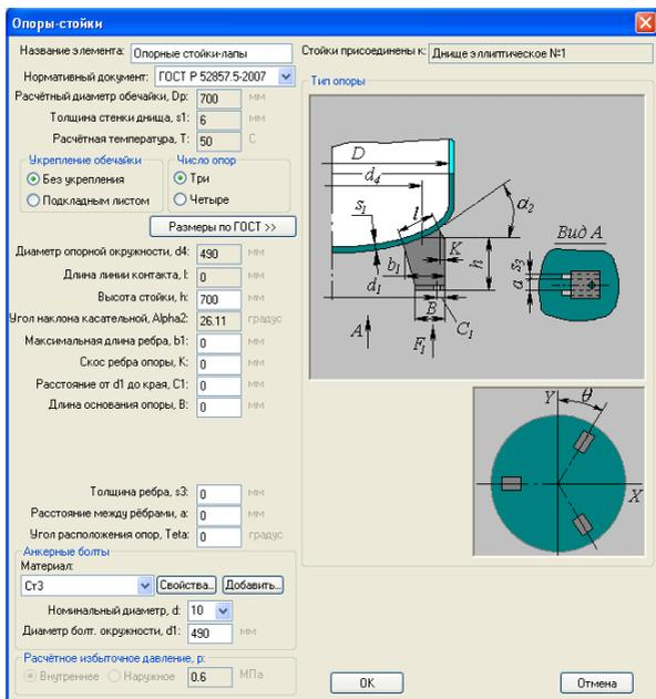
Рис. 3.112 Пластинчатые опоры-стойки
