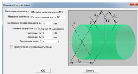
Рис. 3.121. Весовые нагрузки на горизонтальный аппарат
