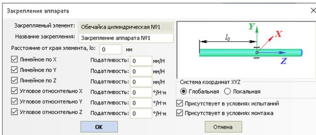
Рис. 3.126 Закрепление аппарата
