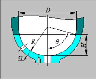
Рис. 3.206 Сферическое днище высокого давления
