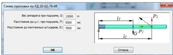
Рис. 3.120 Схема строповки
