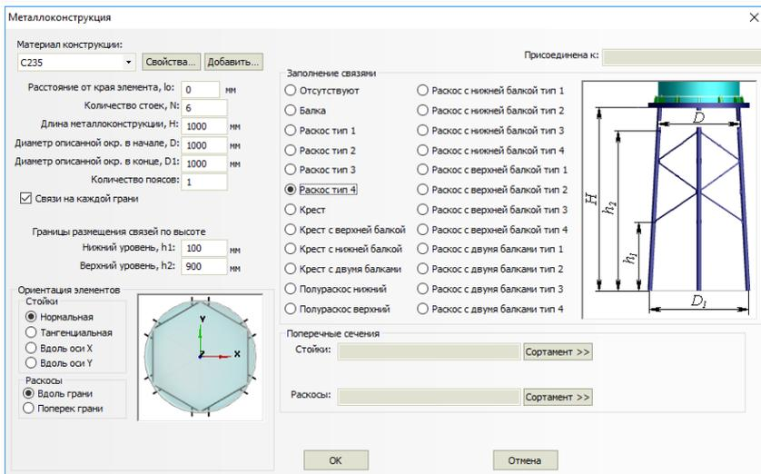
Рис. 3.192. Металлоконструкция
