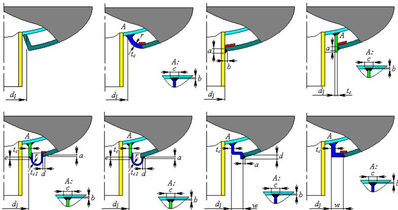
3.15.36. Рис. 3.179. Типы центрального сопряжения по ASME VIII-1 Рубашка, частично охватывающая сосуд
