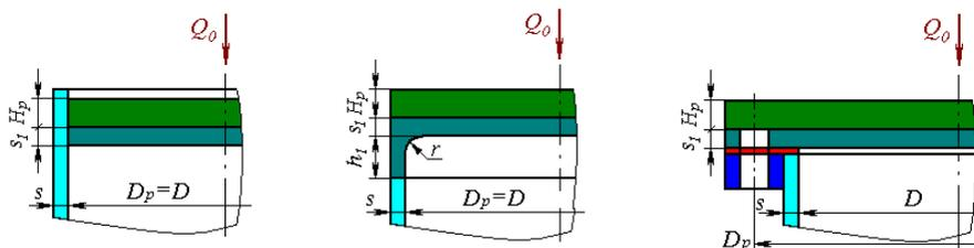
Рис. 3.51 Варианты исполнения дна с ребрами по ГОСТ 34233.2
