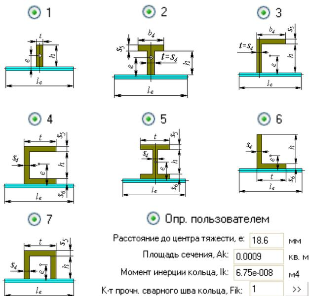
Рис. 3.96 Варианты поперечных сечений колец
