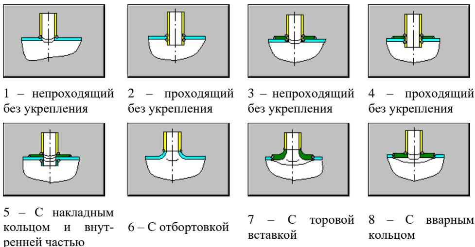
**Рис. 3.64 Варианты исполнения резки**
