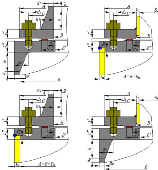
Рис. 3.87 Варианты исполнения реверсного соединения
