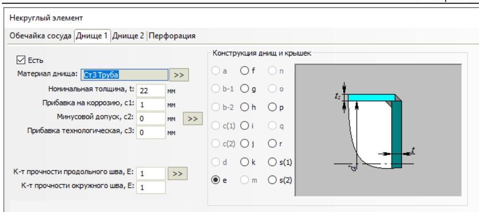
Рис. 3.224 Торцевое днище некруглого элемента
