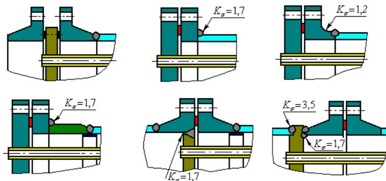
**Рис. 3.160** Трубная решетка теплообменника с U-образными трубами
