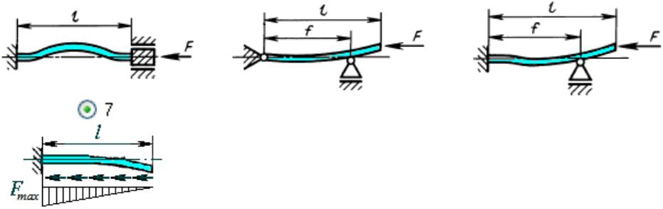
**Рис. 3.36** Расчетные схемы для определения общей устойчивости обечайки
