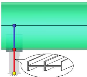
**Рис. 3.103 Моделирование седловой опоры балочными элементами**
