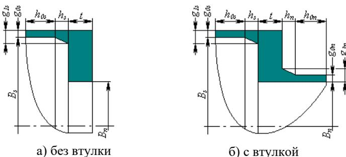
Рис. 3.54 Варианты исполнения днища с отверстием
