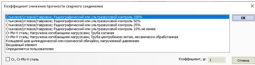
Рис. 3.24 Коэффициент прочности сварного шва по ПНАЭ Г-7-002-86
