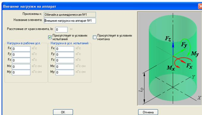
Рис. 3.133. Внешние нагрузки
