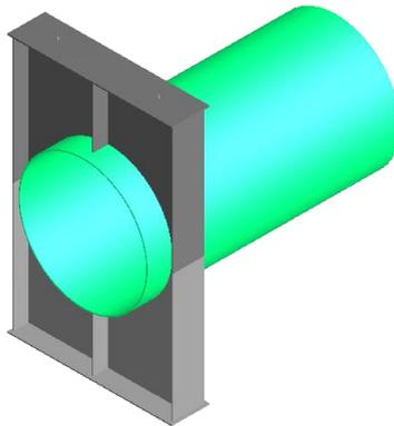
**Рис. 3.102 Опора полного охвата, сформированная из двух элементов**
