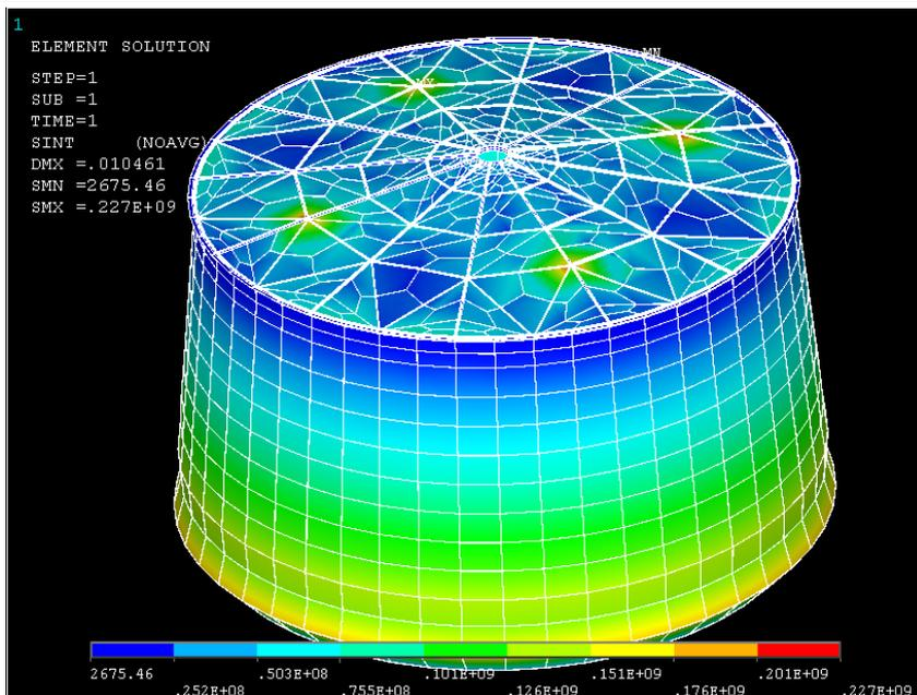
**Рис. 3.233** Пример решения экспортированной модели в Ansys (напряжение гидростатическим давлением, деформированный вид, интенсивность напряжений)
