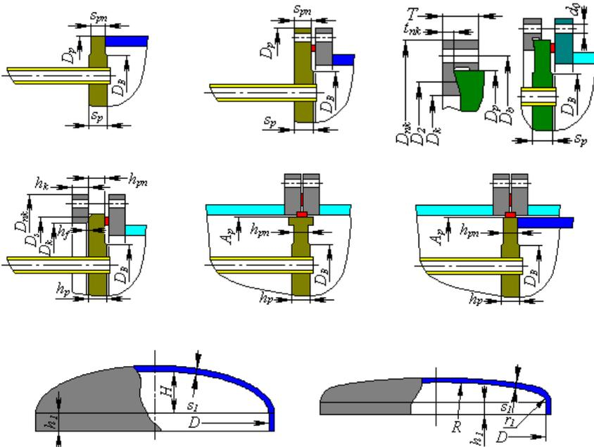
Рис. 3.163. Типы плавающих головок
