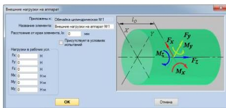
Рис. 3.122. Внешние нагрузки на горизонтальный аппарат
