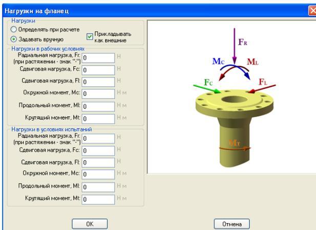
**Рис. 3.85 Нагрузки на фланцевое соединение**
