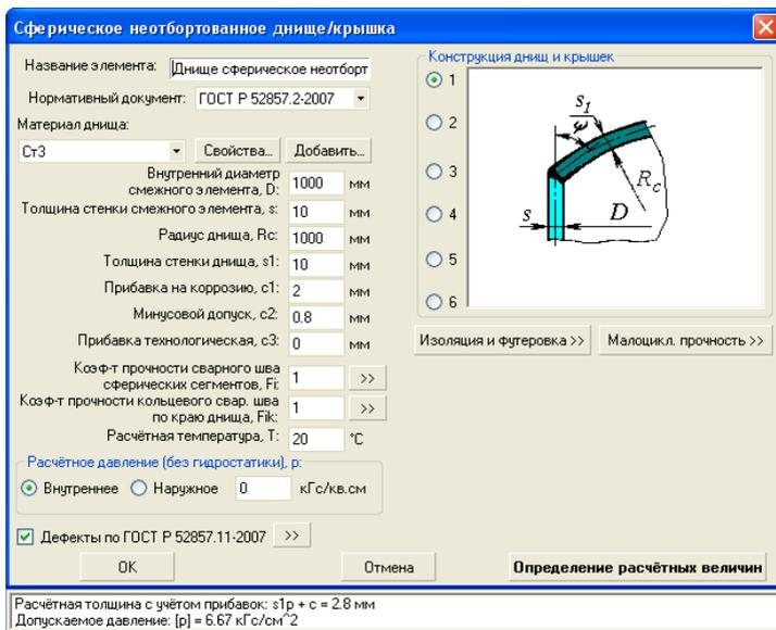
Рис. 3.57 Сферическое неотбортованное днище
