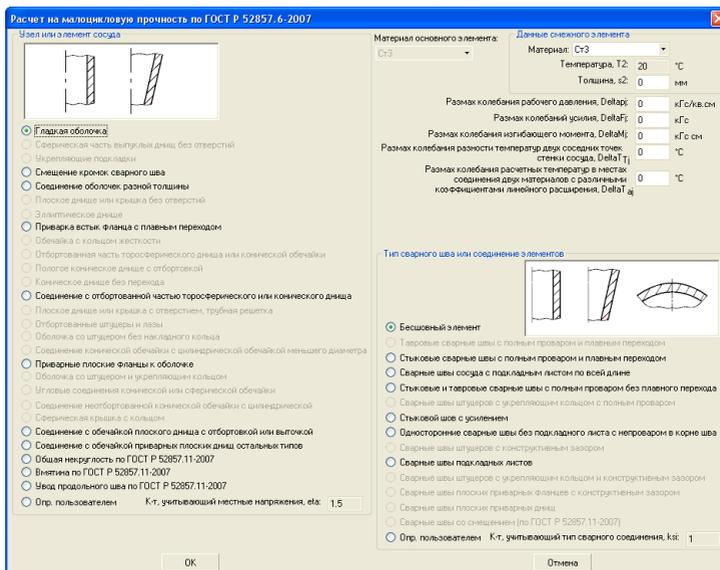
**Рис. 3.30** Параметр концентратора напряжений для расчета малоцикловой прочности
