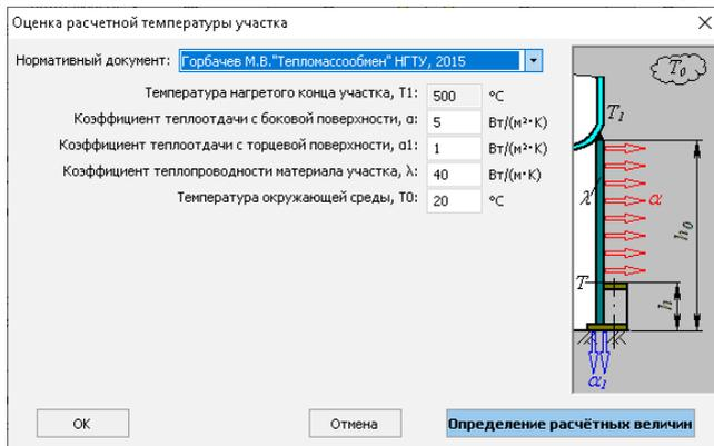
**Рис. 3.136 Оценка температур элементов опоры**
