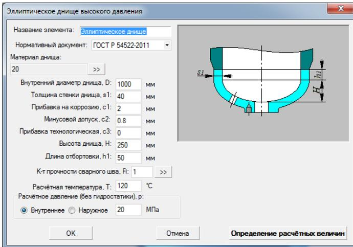
Рис. 3.204 Эллиптическое днище высокого давления
