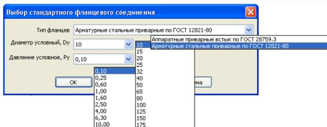
**Рис. 3.80 Выбор стандартного фланцевого соединения**
