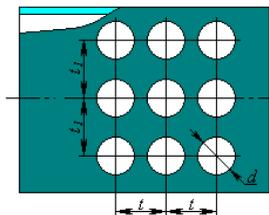
Коридорное равномерное поле
