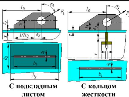
**Рис. 3.117** Варианты исполнения опорного ушка
