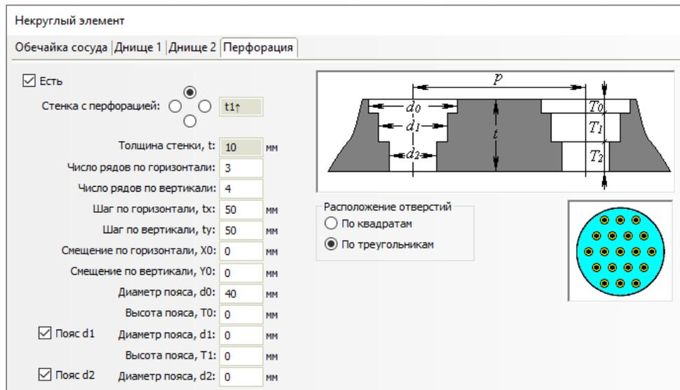
Рис. 3.225 Перфорация стенки некруглого элемента
