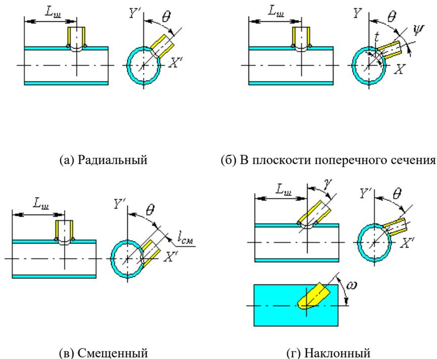
**Рис. 3.60** Варианты расположения штуцера на цилиндрической обечайке
