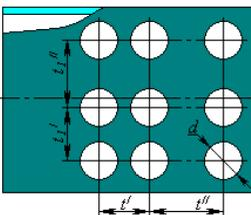
Коридорное неравномерное поле
